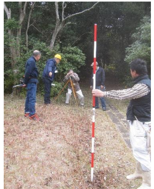
写真⑥=コンパスで杭の間隔と方向を計測
