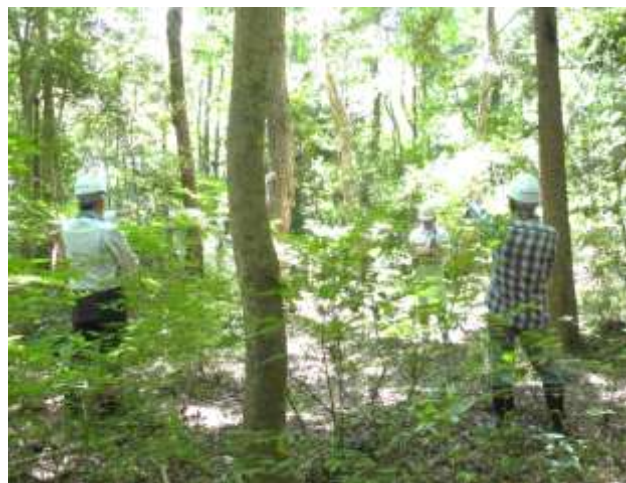
照度計を使って相対照度の調査
