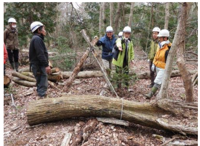
チルホールを使ってクレーンの原理で重量物を動かす
