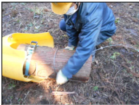
搬出材にワイヤーロープを固定しスキッドコーンの先端から出す
