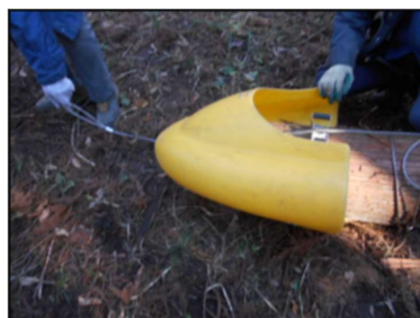
搬出材にワイヤーロープを固定しスキッドコーンの先端から出す
