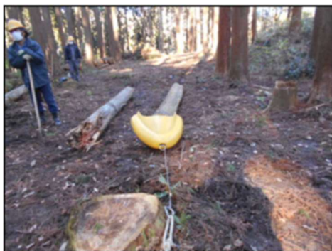
ワイヤーロープと牽引ロープを結び、牽引ロープをロープウインチのドラムに巻き、ロープを引き始めると、搬出材が動き出す
