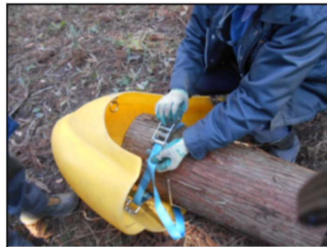
搬出材をスキッドコーンにベルトで固定する(※ベルトは特注)
