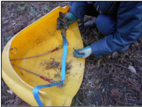
搬出材をスキッドコーンにベルトで固定する(※ベルトは特注)
