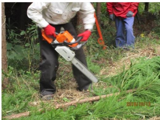
**枝払い：**枝払いは、枝の内部応力を見定めながら、チェーンソーの取っ手の握りを適切に変える。移動はバーが反対側にあるときに行う。
